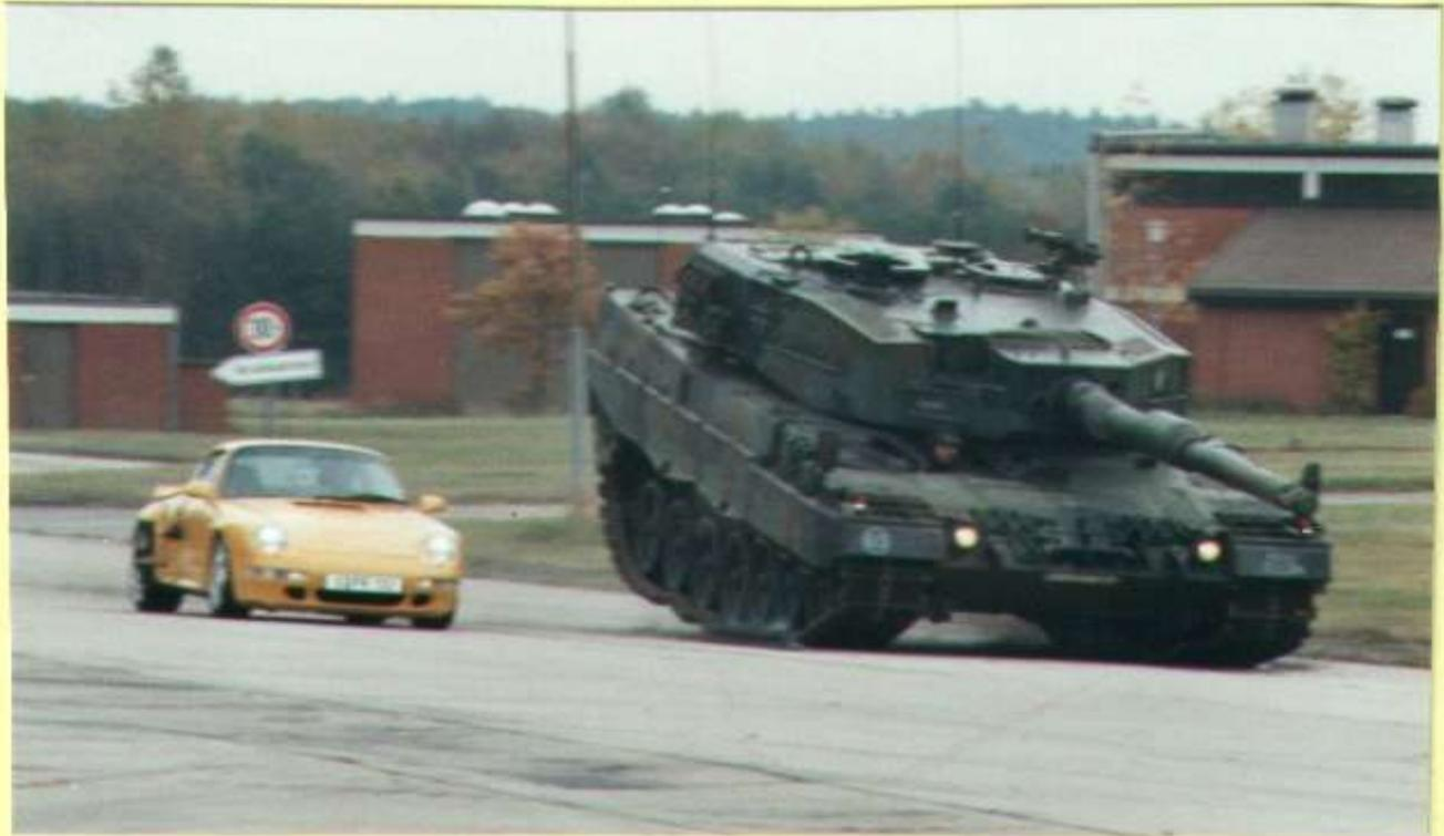
Ehrensache, daß der Zugführerpanzer dafür erhalten mußte und daß HFw Dierks diesen selbst fuhr. Bei Geschwindigkeiten von 30, 50 und 75 km/h mußten beide Fahrzeuge auf einer abgesperrten Strecke innerhalb der TTK eine Vollbremsung durchführen. Der Bremsweg und andere Werte wurden durch einen „Experten“ ermittelt und verglichen.
